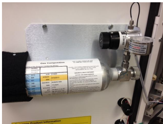
Рисунок 18: Установленный цилиндр проверки
